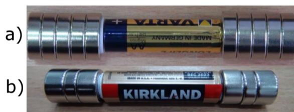
Rys. 5. Pociąg: a) właściwie zbudowany, b) niewłaściwie zbudowany
