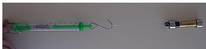
Rys. 7. Pociąg połączony nitką z siłomierzem
