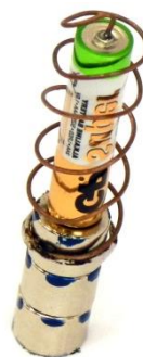
Fot. 1. Wygląd silnika z oscylującym wirnikiem
