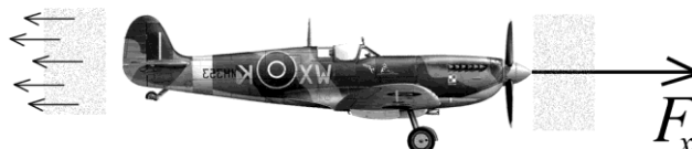
Rys. 4. Wytwarzanie siły ciągnącej samolot. Kręcące się śmigło samolotu „łapie” znajdujące się przed nim powietrze i wprawia je w ruch zmieniając składową poziomą jego pędu
