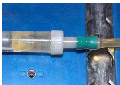
Miód wstrzyknięty do wody w trakcie eksperymentu MFMG na pokładzie Międzynarodowej Stacji Kosmicznej, wykonanego w marcu 2003
