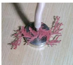
Fot. 2. Osadzanie elektrolityczne miedzi w niejednorodnym polu magnetycznym (w polu magnesu neodymowego)
