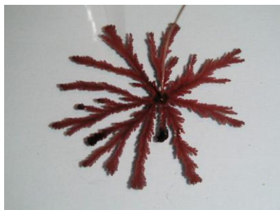
Fot. 1. Osadzanie elektrolityczne miedzi bez pola magnetycznego
