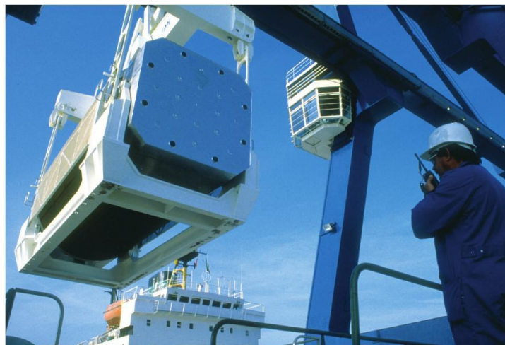
Rys. 7. Przeladunek pojemnika ze zużytym paliwem w porcie w Cherbourgu (All about nuclear energy, AREVA)
