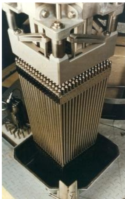
Rys. 5. Element paliwowy reaktora lekkowodnego
