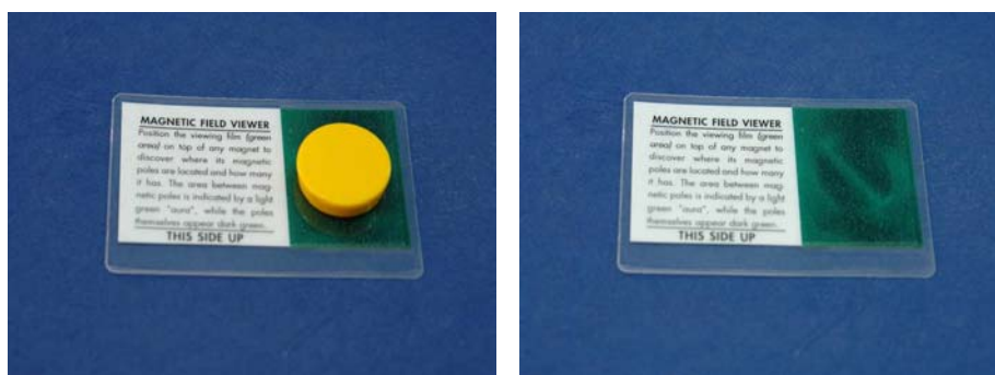
Fot. 2. Magnetyczna pieczętka – magnes o dwóch biegunach na tej samej płaszczyźnie
