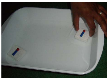
Fot. 1. Pływające magnesy na łożeczkach opisane są w „Rozprawie o metodzie” Kartezjusza. Małe, lekkie magnesy „geomag” służą do pokazania zarówno ziemskiego pola magnetycznego jak i długiego zasięgu oddziaływania magnetycznego
