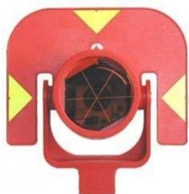
Fot. 2. Pryzmat wykorzystywany do obijania wiązki laserowej w miernictwie geodezyjnym.
