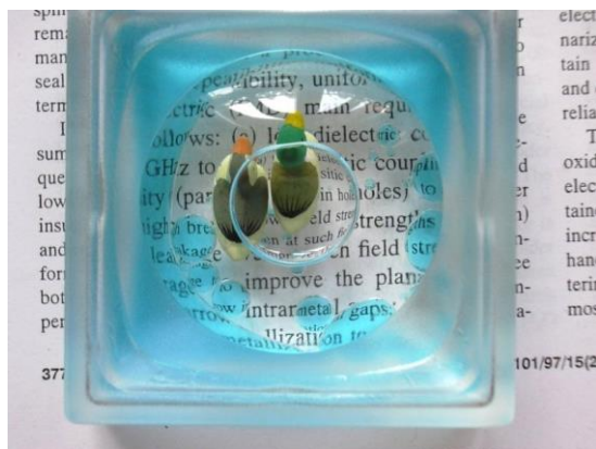
Fot. 1. Kaczki w szklanej popielniczce: jest to przykład dwóch cieczy niemieszających się. Ciecz niebieska, mimo że cięższa, ma niższy współczynnik załamania niż ciecz bezbarwna. Potrząsanie popielniczki wytwarza bąbelki jednej cieczy w drugiej (lub bąbelki powietrza), które działają jak soczewki rozpraszające. Taki sam efekt można uzyskać, nalewając do słoika 0,5–1 cm 3 oleju, a następnie gwałtownie mieszając w celu dla utworzenia bąbelków powietrza; jeszcze lepiej zamieszać olej z wodą
